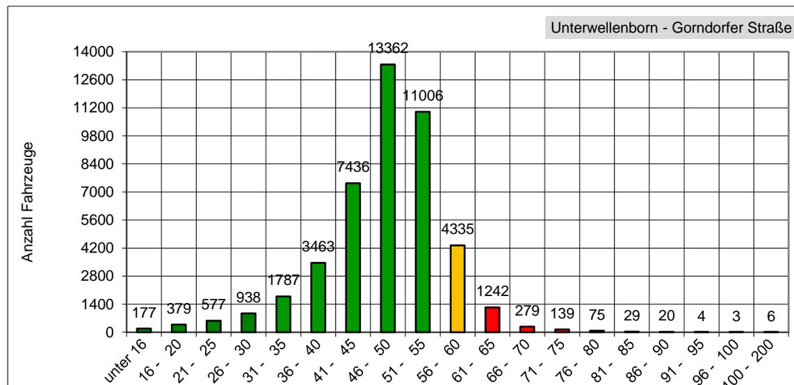
v<sub>max</sub>: Dieser Wert wird in km/h ausgegeben und stellt die am schnellsten gefahrene Geschwindigkeit während des Messzeitraums dar.
